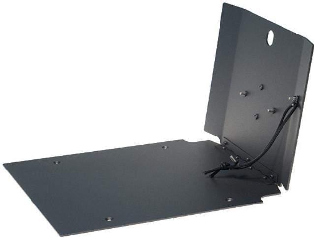
Die Heckklappe ist mehr als die Halterung des Kennzeichens. Sie verschliesst mit dem Helmfach die einzige abschliessbare Box des Standard-Fahrzeugs (DXP, DXS, DX2, MaXX2). Das Helmfach hat im Laufe der Zeit seinen Zweck etwas geändert. Moderne Integralhelme finden darin keinen Platz, die klassischen Jethelme ohne Kinnteil können jedoch gut darin verstaut werden.
