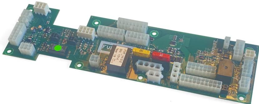
Die Schalter und Sensoren an Fahrzeugen erzeugen viele Informationen, die durch Kabel übertragen, eine Aktion am Fahrzeug auslösen. Alle diese Signale laufen im FVP (Fahrzeug-Verteil-Print) zusammen und werden von da aus an die richtigen Kabel und Empfänger weitergeleitet.
