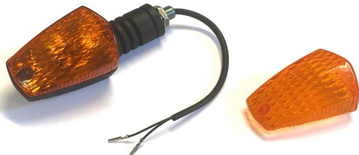
Seit 2007 verbaut KYBURZ Blinker der Firma ECIE aus Italien. Der handelsübliche Blinker wird für KYBURZ betreffend Verkabelung speziell konfektioniert. Damit die Sicherheit im Strassenverkehr gewährleistet ist, hat der Blinker verschiedene Zertifizierungen und Prüfungen durchlaufen.
