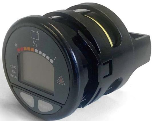
Alle Fahrerinnen und Fahrer von KYBURZ-Fahrzeugen schauen regelmässig drauf: auf die Anzeige Curtis enGage®II. Sie zeigt den Ladestand der Batterie und die aktuelle Geschwindigkeit an. Beim Anschalten des Fahrzeugs wird kurzzeitig der Gesamtkilometerstand eingeblendet. Die Anzeige ist mit der zentralen Steuerung verbunden und bezieht dort die Informationen. Beide Teile stammen von der Firma Curtis.
